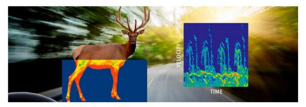
Das intelligente Straßenradar kombiniert Radar, optische Kameras und Infrarotsensoren mit einem neuronalen Netzwerk. Dazu kommuniziert das Radarsystem mit Sensoren am Straßenrand.
